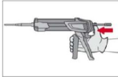
Une fois l'injection terminée, dépressurisez le système d'injection en appuyant sur le levier de détente. Vous éviterez ainsi que la résine ne sorte de façon inopinée de la buse mélangeuse.
